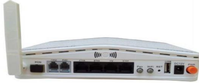
شكل (2-30): Optical Network Unit
